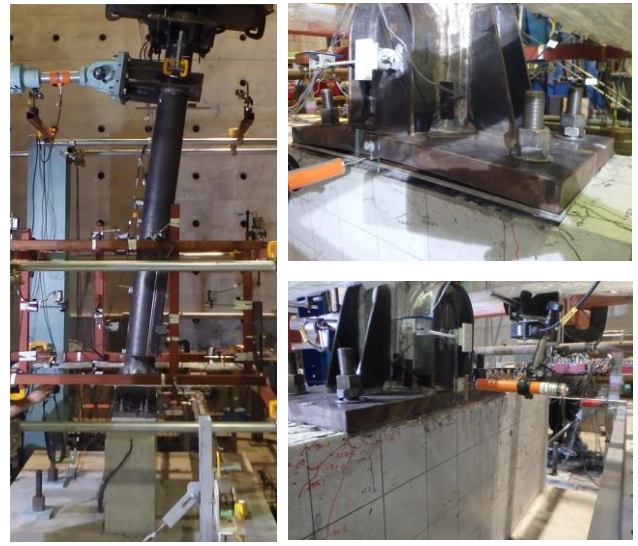
写真-2 照明柱 (リブあり) 最大荷重時の全景:左, 基部(引張側):右上, 基部(圧縮側):右下
