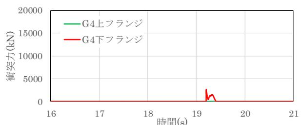
図-17 衝突バネ反力時刻歴 (A2)
