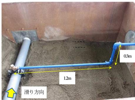
写真-2 クランク配管状況
