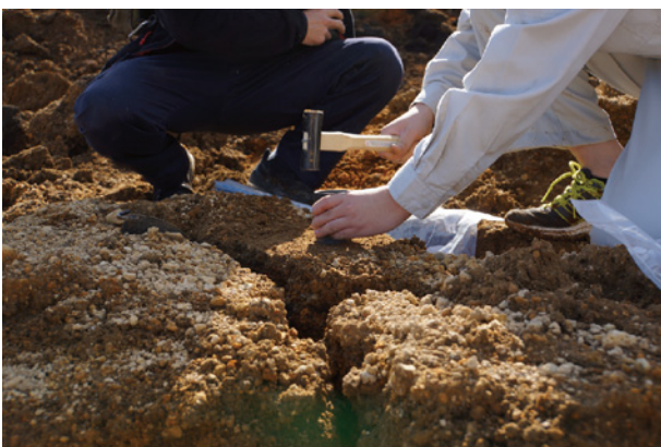
a)ハンマーによるモールド管の挿入
