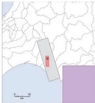
図-4 2018年北海道胆振東部地震と周辺の震源断層モデルおよびモデル化領域(文献 8,9) を基に作成)
