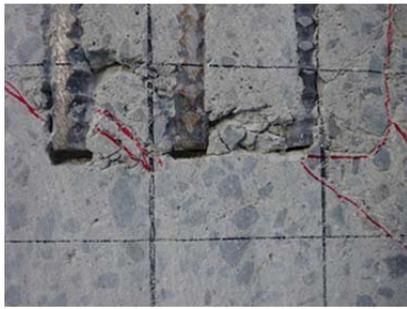
図-14 突起アンカー鉄筋の抜け出し (Case-3)
