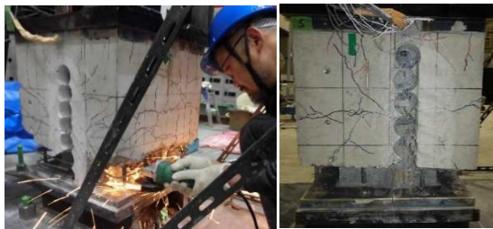
(a) 鉄筋切断状況 (b) 撤去後の様子
