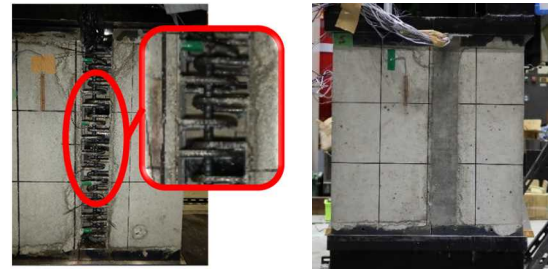
(a) 軸鉄筋配置 (b) 養生完了
