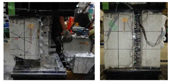
(a) 取り外し状況 (b) 新外殻部材設置
