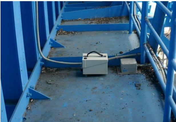
図-11 常時微動計測状況（中央：ポータブル微動計，右：加速度計 a-11-s）
