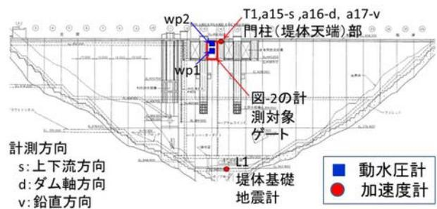
図-1 計測対象ダムの上流面図と堤体計測箇所
