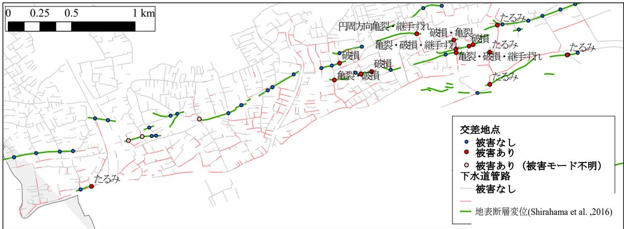
図-3 益城町における下水道埋設管の被害形態
