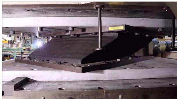
図-6 45°方向水平荷重試験状況
