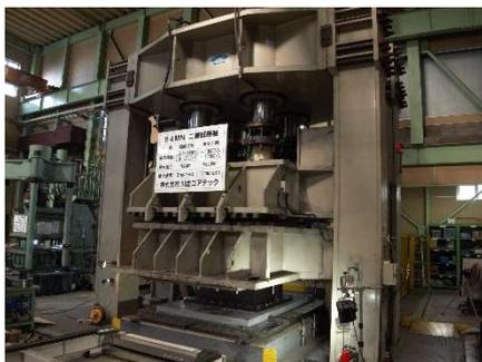
写真-2 二軸載荷試験機
