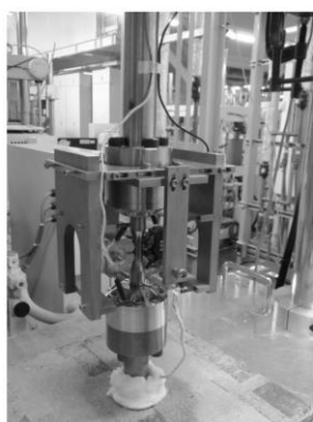
写真-1 低サイクル疲労試験の試験状況
