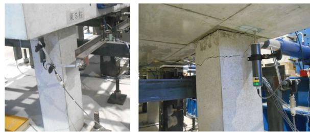
写真-2 東5柱の損傷状況 (Case-22終了時: 目標変位 30mm)
