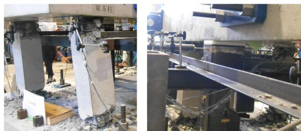
写真-6 東5柱 (通常柱) 東2柱 (自重補償柱) の状況
