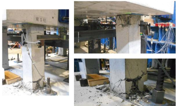
写真-3 東5柱の損傷状況
