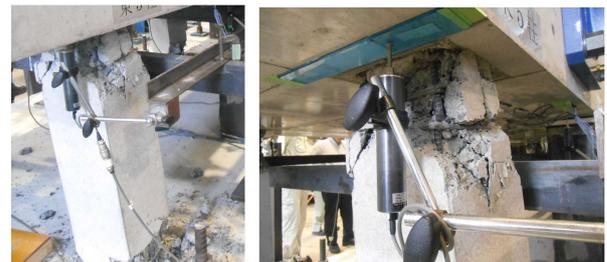
写真-4 東5柱の損傷状況
