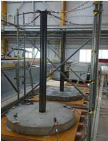
写真-1 実験模型(手前：円形，奥側：正八角形)
