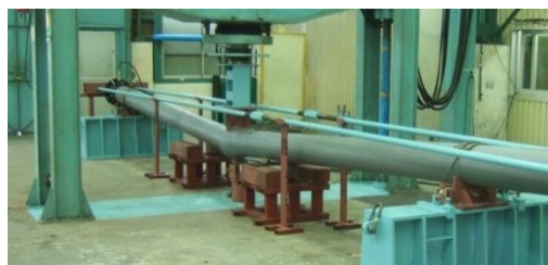
図-11 継手ばね（回転ばね）設定のための実験状況
