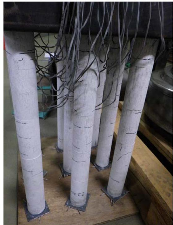
写真-1 杭の損傷（遠心力模型振動実験）
