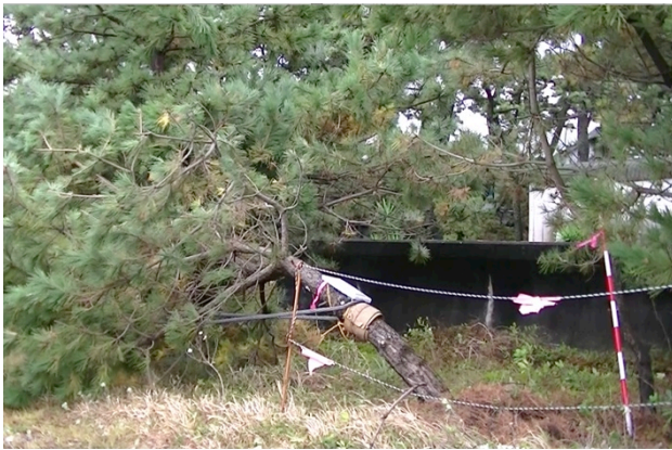
図-3 引き倒し試験の状況（上：試験前，下：試験後）
