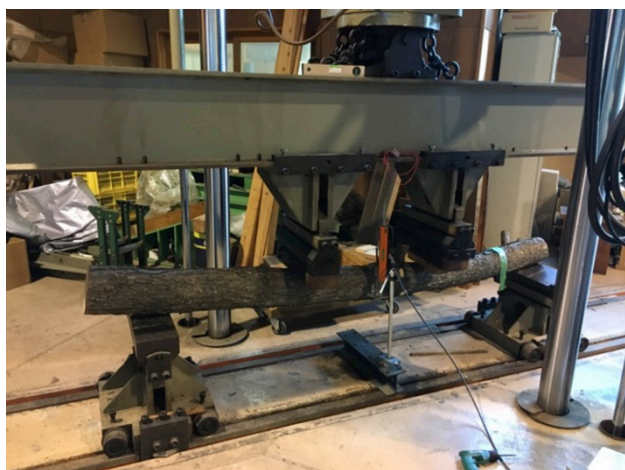
図-13 実大木材曲げ試験の実施状況
