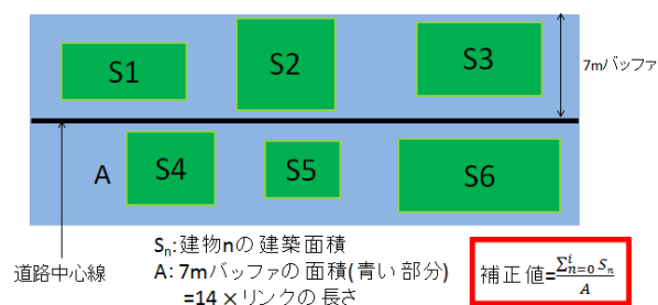
図-2 補正值算出の概略図
