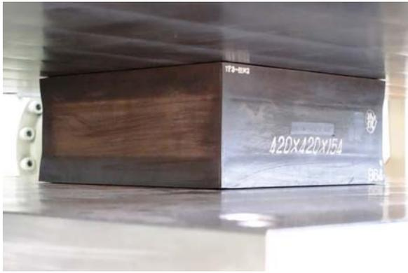
写真-2 軸応力引張2MPa、せん断ひずみ300%を載荷した後のゴム支承の変形様子 ( $S_i=11.11$ )
