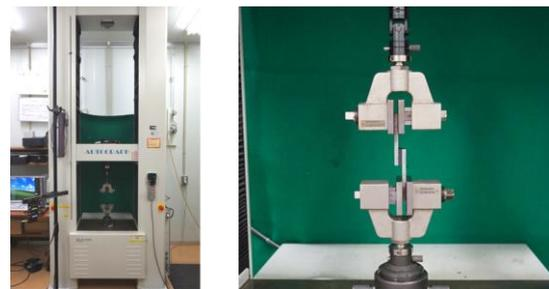
図-11 精密万能試験機（引張せん断試験）
