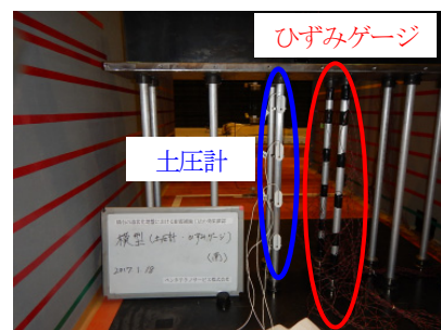
写真5 ひずみゲージ・土圧計設置状況
