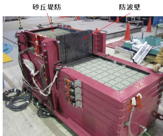
図-5 実験模型 (模型縮尺 1/30 )
