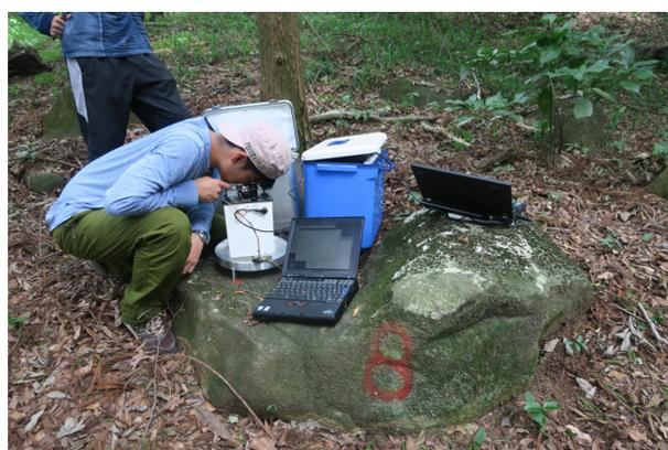
図-9 筑波山重力検定路線の重力基準点 (No.8) における観測の様子。右奥の青いケースがデューワー瓶をおさめたクーラーボックス。左の白いセンサは LaCoste & Romberg 製の G 型相対重力計。
