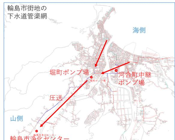
図-2 輪島市下水道と下水(污水)の流れ
