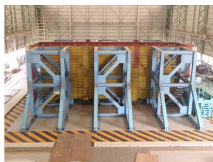
写真-2 振動台全景(実験土槽あり)
