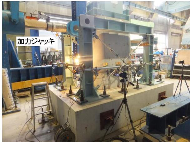
図-6 静的打継目破壊試験状況 (供試体 No.3)
