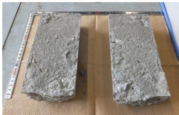
図-5 打継目の割裂破壊状況 (テストピース)
