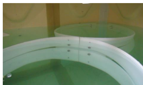
写真-3 8の字形浮体式制振装置の設置状況
