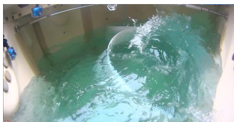
写真-6 1次モード 0.60Hz ±10mm の制振時
