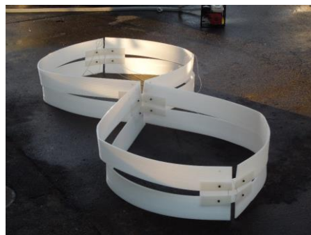
写真-2 8の字形浮体式制振装置
