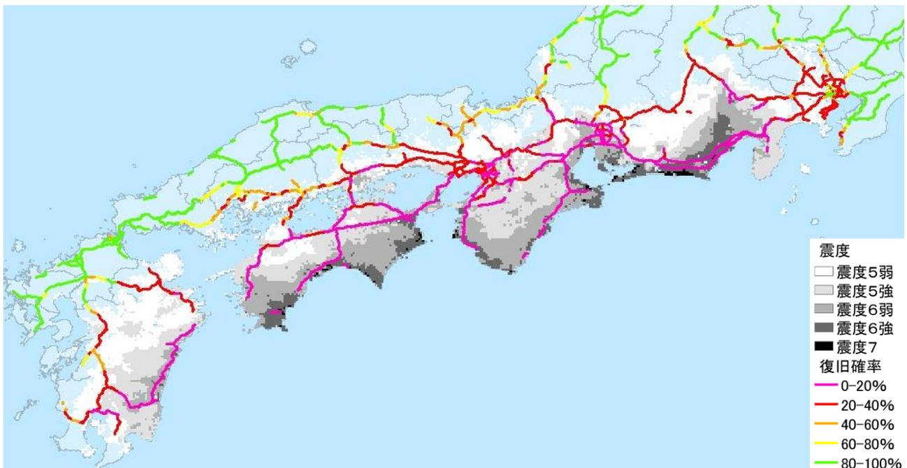
図-15 南海トラフ地震における震度分布と式(6)による地震発生1日(24時間)後の高速道路の復旧確率
