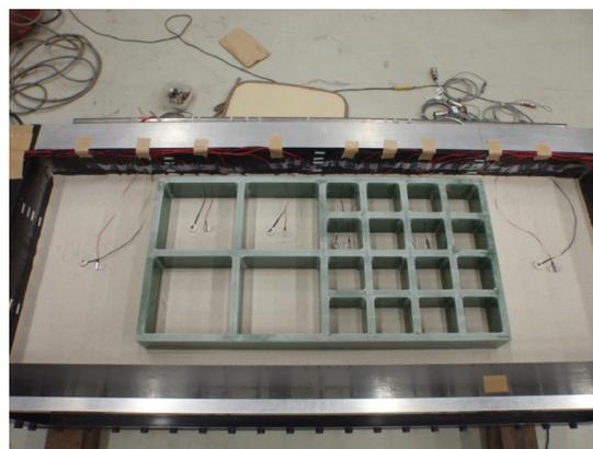
Case-2(浮型格子)の模型地盤作成状況
