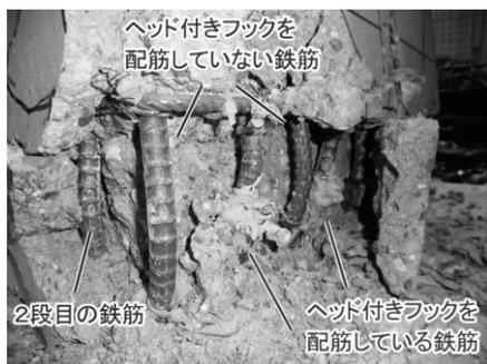
図-18 C100-WHの軸方向鉄筋の座屈発生後の様子
