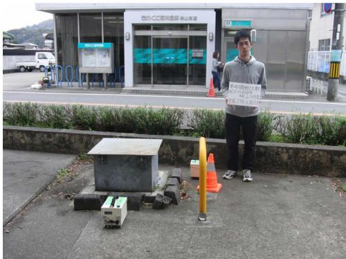
写真-2 常時微動計測状況例 (基準点)
