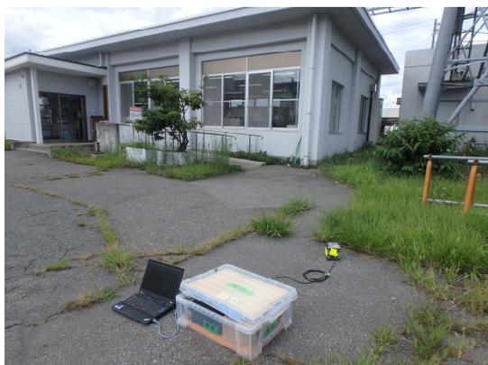
写真-1 常時微動計測状況例
