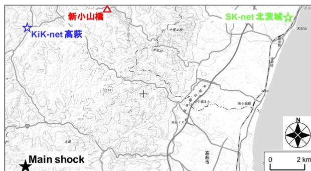
図-1 2016年茨城県北部の地震の震源域に位置する新小山橋(県道22号)とその周辺の強震観測点の分布
