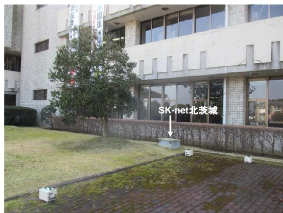
写真5 常時微動の計測状況(SK-net北茨城)
