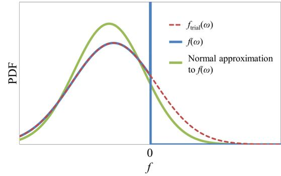
図-3 降伏関数の確率分布の変化 ( $f_{\text{trial}}(\omega)$ ， $f(\omega)$  及び正規分布で仮定した  $f(\omega)$ )
