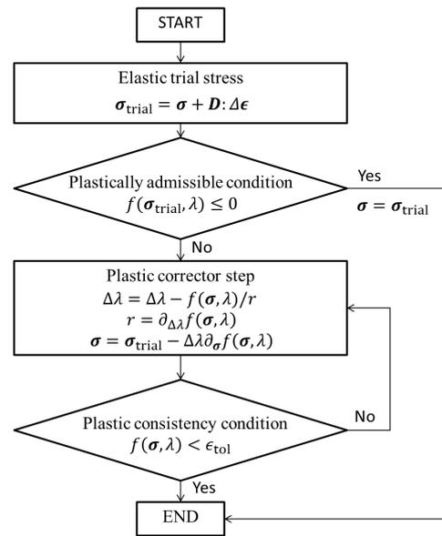
図-1 陰的弾性予測子/リターンマッピングアルゴリズムの評価フロー
