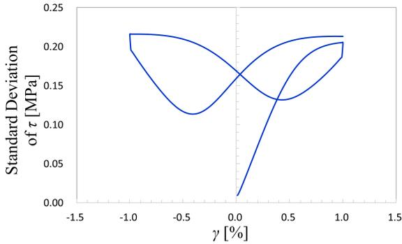
図-9 載荷除荷サイクルにおけるせん断応力の標準偏差の歪依存性 ( $\gamma = \pm 1\%$ )
