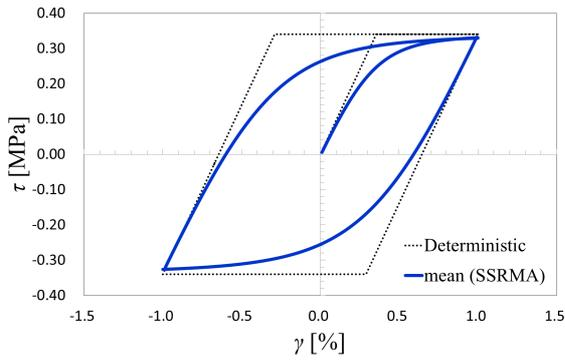
図-8 載荷除荷サイクルにおける応力歪関係の評価結果 ( $\gamma = \pm 1\%$ )
