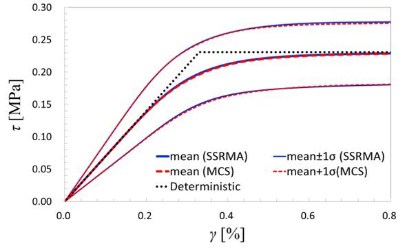
図-5 SSRMA による応力歪関係の評価結果 ( $E = 70\text{MPa}$ (変動係数 30%),  $\sigma_Y = 0.4\text{MPa}$ (変動係数 20%))
