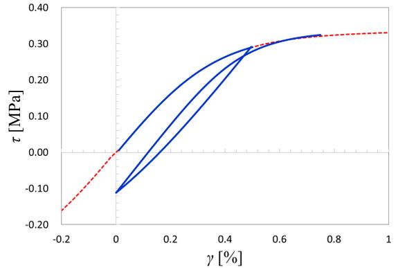
図-11 履歴曲線の評価結果 (非対称載荷除荷サイクル)
