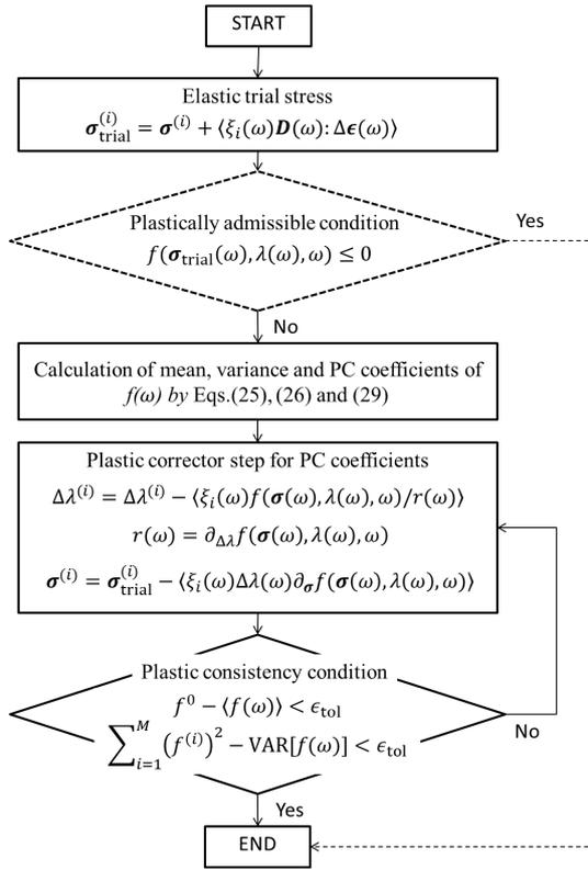
図-4 SSRMA の評価フロー
