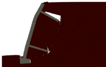
図-14 耐震補強を施した切土地盤モデルの傾斜実験に対する解析結果 ( $\tan \theta=0.5$ )
