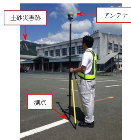
写真-1 実施したネットワーク型 RTK 法 VRS 方式の GNSS 測量
