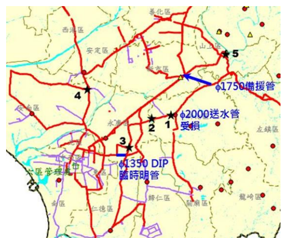
図 - 5 送水管の管路網と大口径送水管の被害位置 1)
