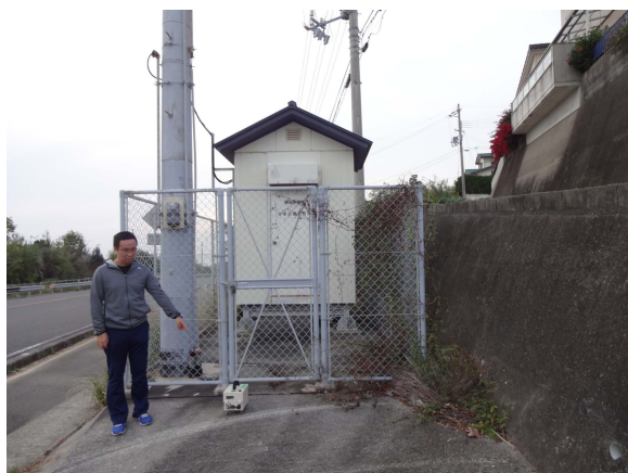
写真-1 常時微動計測状況 (MLIT印南での一例)
