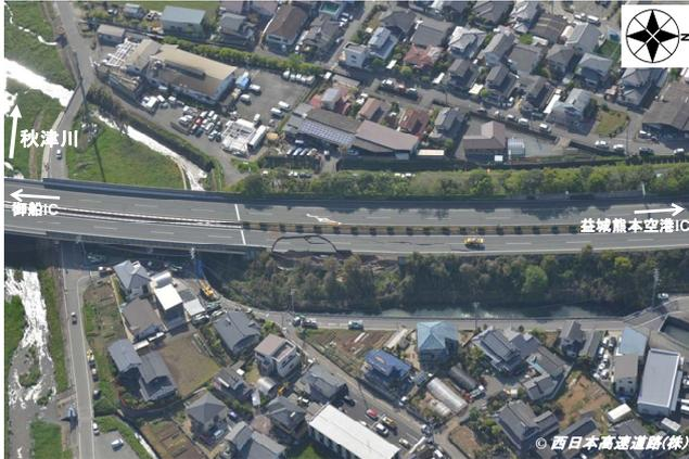
写真-2 前震の翌日(4月15日)に撮影された被災盛土の上空写真
