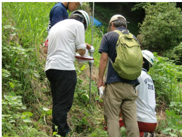
図-9 簡易貫入試験実施状況
