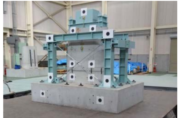
写真-2 振動台実験供試体 7)
