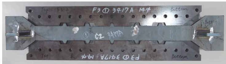
写真-2 供試体組み立て
