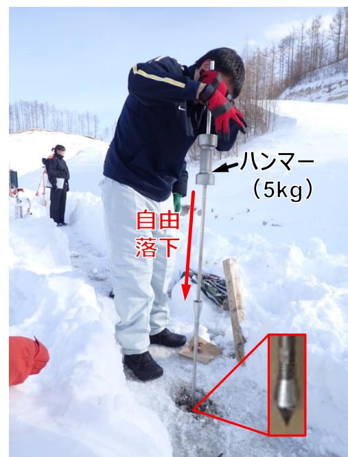
図-4 簡易動的コーン貫入試験の実施例
