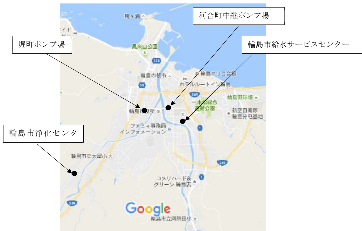
図-1 輪島地区の上下水道施設
