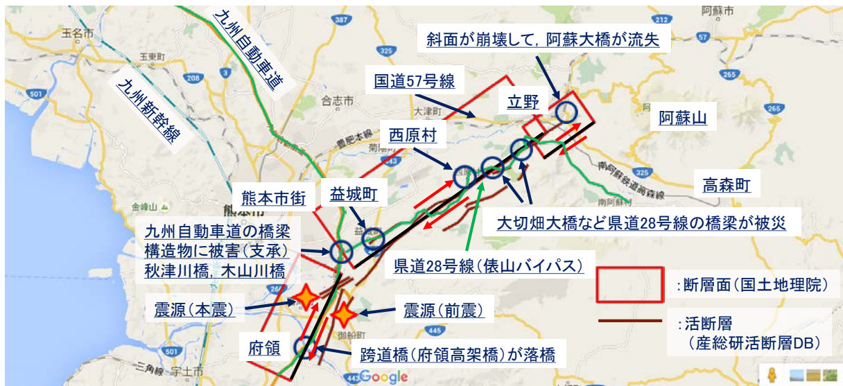
図-1 2016年熊本地震における橋梁構造物の被害発生地域と起震断層 5), 6)
