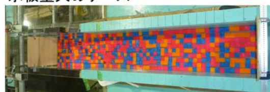
図-2 水路内における氷板模型の設置状況
