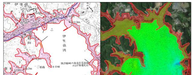
図-11 津波被害報告<sup>4)</sup>と解析結果の比較
