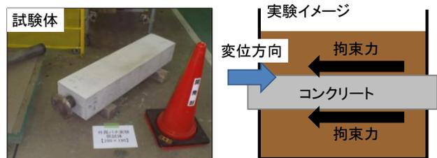
図 4 外周バネ試験体と試験イメージ
