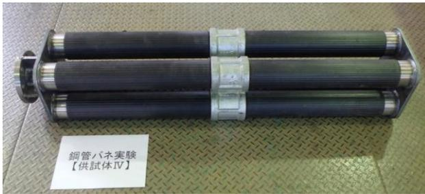
図 5 鋼管バネ試験試験体(2×2 ソケット有)
