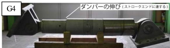
写真6 ダンパーの損傷状況 (A1G2~G4)
