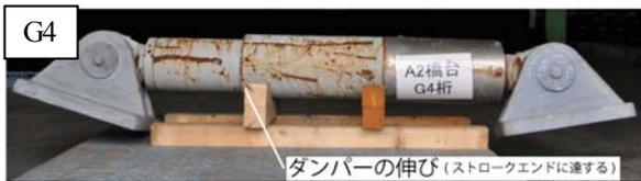
写真7 ダンパーの損傷状況 (A2G2~G4)
