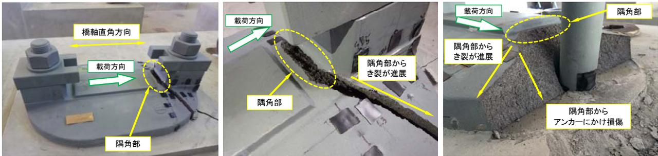
写真7 水平载荷実験後の供試体損傷部(750kN タイプ)
