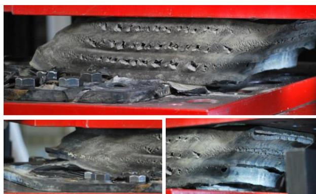
図-2 ゴム支承の破断時の写真
